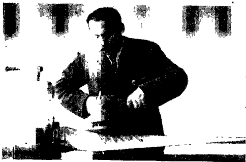
Фиг. 302. Шлифование поверхностей лопасти.
