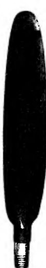
Фиг 53 Форма прикомлевой части с резким переходом от пера лопасти к комлевой части
