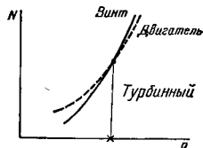
Фиг. 224 Сравнение характеристики поршневого двигателя и газовой турбины.
